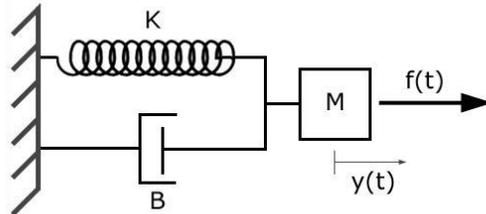
(A).  $m = 1 \text{ kg}$ ,  $b = 4 \text{ Ns/m}$ ,  $k = 2 \text{ N/m}$ ;  $f(t) = \text{Impulso Unitário (Delta de Dirac)}$
