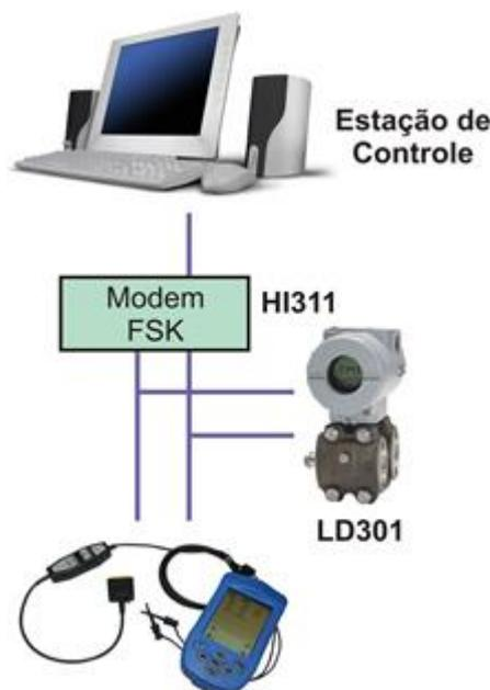
Figura 36 – Conexão HART ponto-a-ponto
